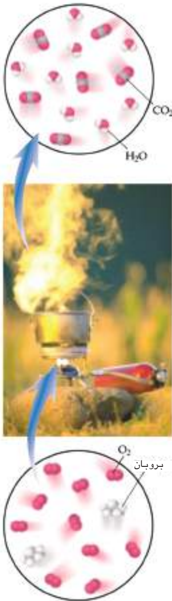
الشكل(3-4) احتراق الالكانات في الهواء ينتج غاز CO 2 وبخار الماء H 2 O .
