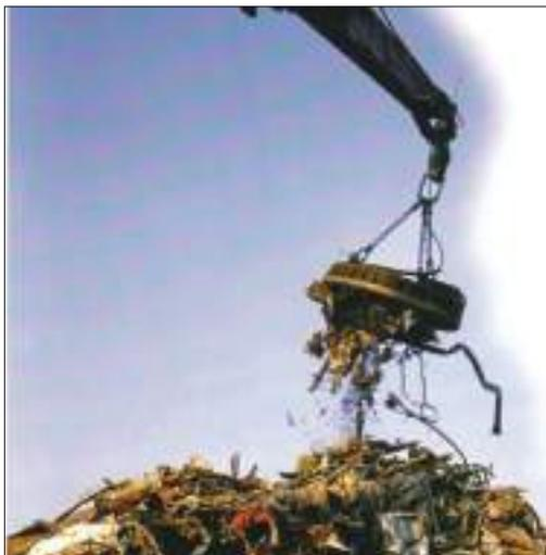
الشكل (18) مغناطيس كهربائي يستعمل لرفع
