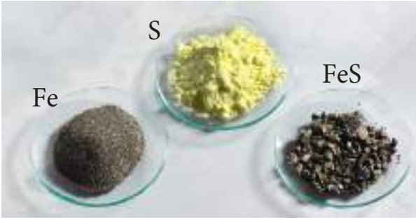
نتج تفاعل عنصر الحديد مع عنصر الكبريت لتكوين مركب كبريتيد الحديد
