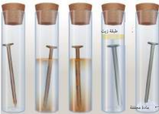
هواء جاف ماء مغلي ماء مملح+هواء ماء+هواء هواء مادة مجففة
