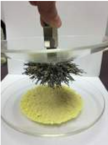
تنفصل برادة الحديد عن عنصر الكبريت بالمغناطيس
