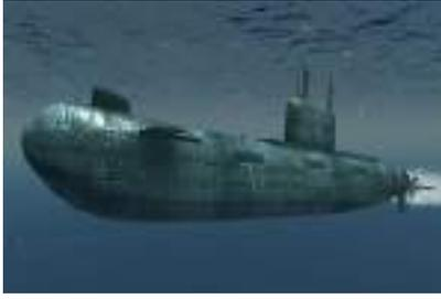
◀ **الغواصة:** هي باخرة تبحر على سطح الماء كجسم طافٍ، أو تغطس بكاملها تحت الماء، وهي تغوص عندما تعمل على ادخال الماء إلى مستودعاتها الداخلية، إذ يزداد وزنها فتغطس ثم تعود إلى السطح عندما يفرغ الماء بوساطة احلاله بهواء مضغوط.
