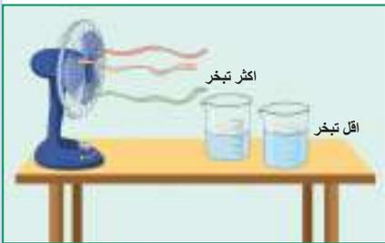
٣ **سرعة الرياح:** ان تعرض السائل لتيارات الهواء يزيد من سرعة تبخره فالملابس تجف بسرعة عندما تتعرض لرياح قوية، كما ان عمل مبردة الهواء يعتمد على اساس مرور الهواء على نشارة الخشب المبللة إذ يمتص الحرارة اللازمة لتبخره من نشارة الخشب المبللة فيبرد الهواء المار خلال النشارة ويصل الينا بارداً.
