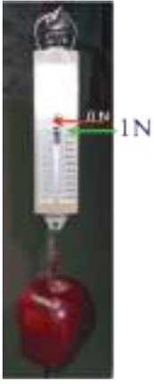
يمكنك قياس مقدار القوة باستخدام الميزان النابضي، إذ يزداد طول نابض الميزان النابضي بزيادة القوة المؤثرة، وعند تعليق جسم كتلته (1kg) مثلاً، فإن مقدار القوة التي يقيسها الميزان النابضي تساوي (9.8N) كما يظهر في الشكل.
