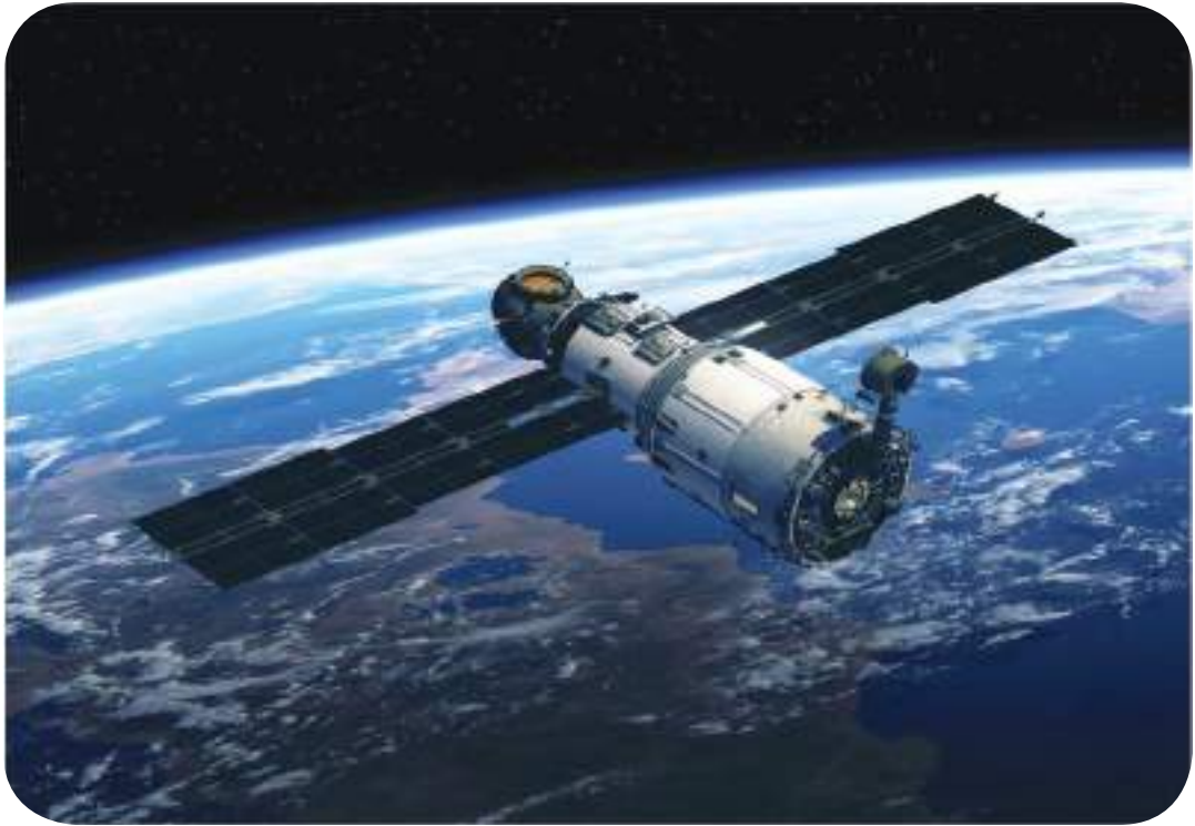
تُزود الأقمار الصناعية بالألواح الخلايا الشمسية لمدّها بالطاقة الكهربائية
