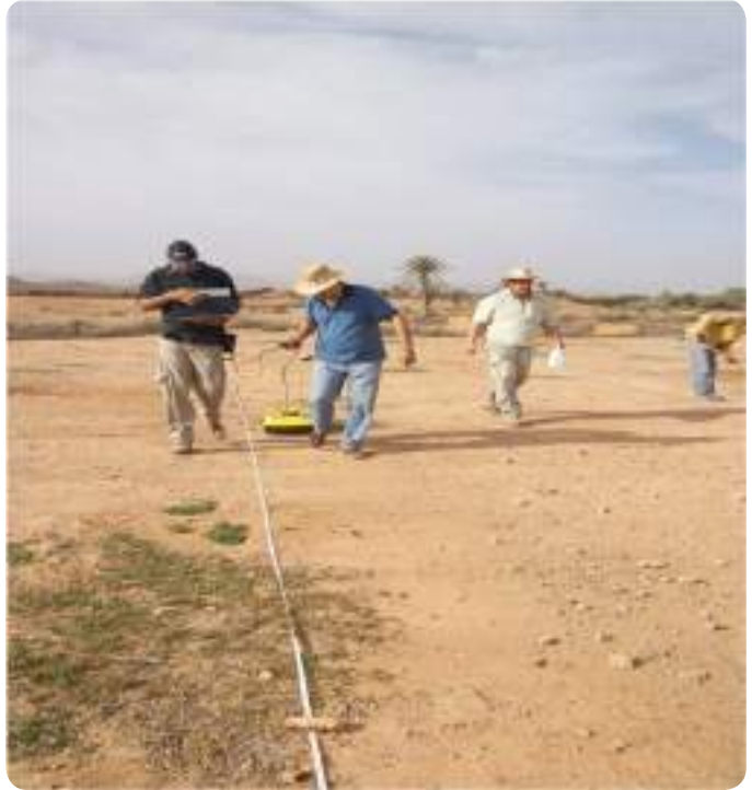
▲ شريط القياس من أدوات قياس الطول
