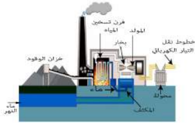
▲ محطة لإنتاج الطاقة الكهربائية من الوقود الأحفوري (للاطلاع)
