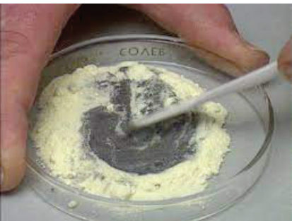
خلط برادة الحديد مع الكبريت
