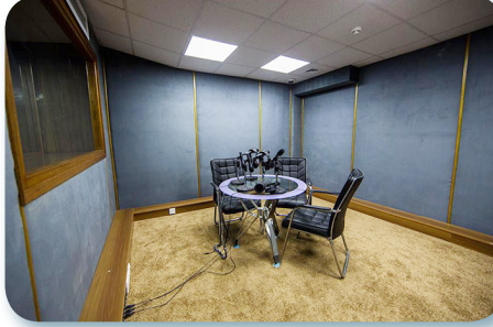
تستعمل ألواح ماصة للصوت في المسارح والاستديوهات
