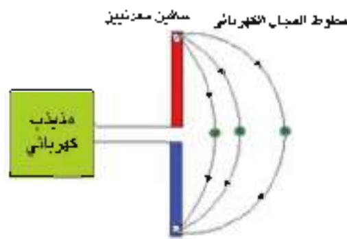
شكل (8) يوضح تباعد خطوط المجال الكهربائي عند ازدياد الفولتية على سلك هوائي الإرسال
