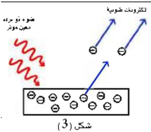
في النصف الأخير من القرن التاسع عشر، أوضحت التجارب أن الضوء الساقط (ذو تردد معين مؤثر) على سطوح معادن معينة يسبب انبعاث الإلكترونات من تلك السطوح، لاحظ الشكل (3). إن هذه الظاهرة تعرف بالظاهرة الكهروضوئية والالكترونات المبعثة تسمى بالالكترونات الضوئية (photoelectrons). إن إن أول من لاحظ هذه الظاهرة عملياً هو العالم هيرتز (Hertz) وذلك في عام (1887).
