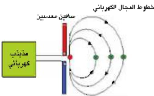
شكل (9) يوضح تقارب خطوط المجال الكهربائي عند تناقص الفولتية
