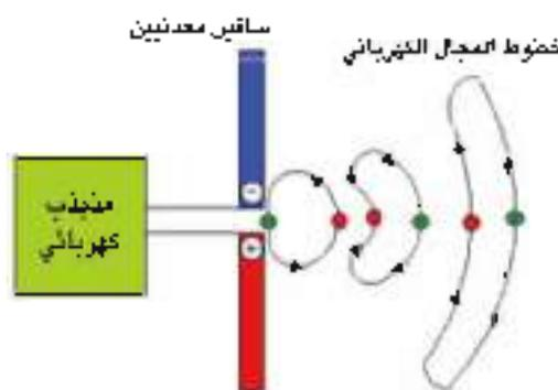
شكل (10) يوضح انفصال خطوط المجال الكهربائي عن الهوائي لحظة انقلاب الفولتية
