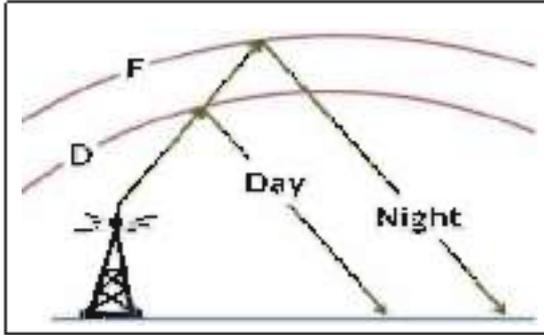
تشمل هذه الموجات جميع الترددات التي تقع بين (2-30) MHz ويعتمد هذا النوع من الاتصالات على وجود طبقات الأيونوسفير (Ionosphere layers) وهي طبقات عالية التأين إذ تحكس الموجات السماوية إلى الأرض. لاحظ الشكل (24).
