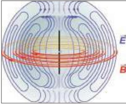
شكل (11) يوضح انبعاث الموجات الكهرومغناطيسية من هوائي الإرسال بعد ان تنغلق خطوط المجال الكهربائي والمغناطيسي المرافق له
