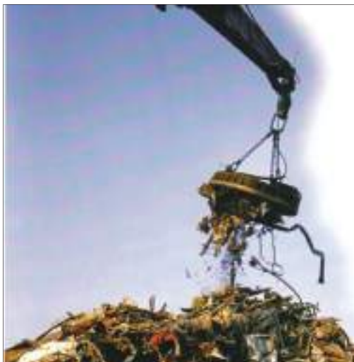
الشكل (18) مغناطيس كهربائي يستعمل لرفع
