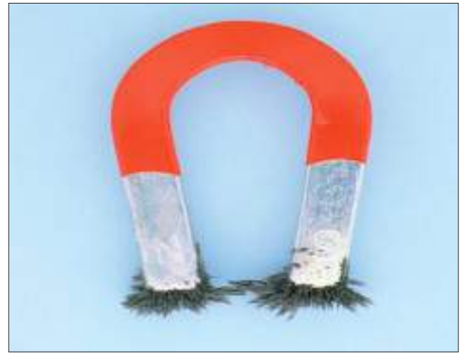
الشكل (9-c) تجمع برادة الحديد بتركيز عالي عند القطبين المغناطيسيين لمغناطيس بشكل حرف U.
