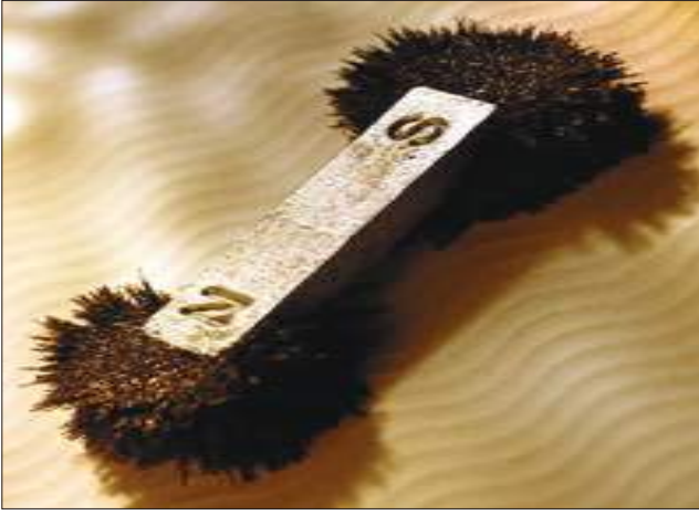
الشكل (9-a) يوضح تجمع برادة الحديد بتركيز عالي عند القطبين المغناطيسيين لساق مغناطيسية مستقيمة.
