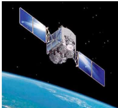
**الأقمار الصناعية:** يستعمل القمر الصناعي بصفة أساسية في الاتصالات مثل إشارات التلفاز والمكالمات الهاتفية في جميع أنحاء العالم والتنبؤ بالطقس وتعقب الأعاصير، إذ تدور هذه الأقمار بسرعات محددة في مدارات خاصة بها حول الأرض، وتحسب سرعة القمر المدارية بالعلاقة التالية:  $v = \sqrt{4 \times 10^{14} / r}$  ، إذ  $r$  نصف قطر المدار (بعد القمر عن مركز الأرض). ما سرعة القمر إذا كان نصف قطر المدار 300km ؟
