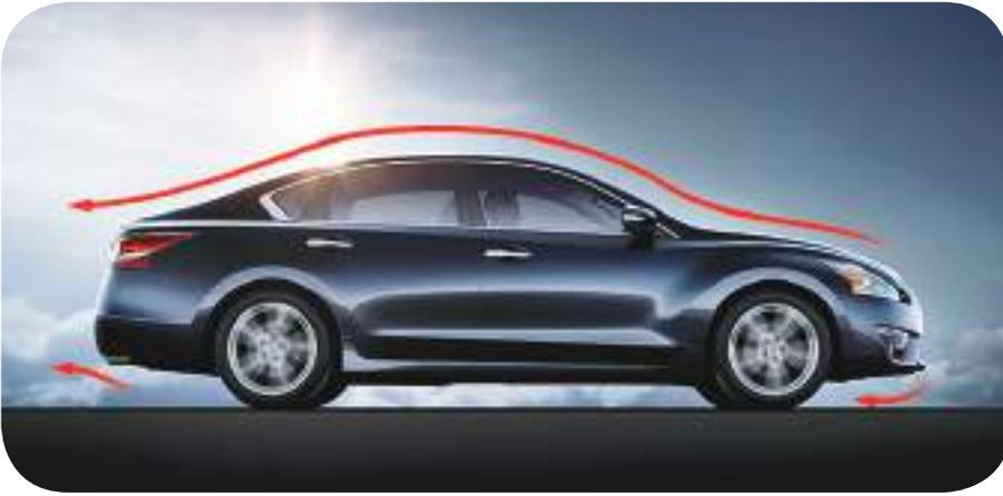
يقلل تصميم الشكل الانسيابي للسيارات الحديثة من مساحة سطح الجسم المعرض للهواء وبالتالي تقل قوة الاحتكاك بالهواء
