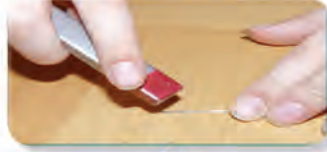
تصبح الأبرة مغناطيس عند دلكه بأحد طرفي المغناطيس
