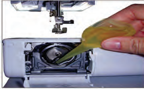
تزييت الآلات الميكانيكية لتقليل الاحتكاك الذي يحصل بين اجزائها المتلامسة كما في آلة السبائك
