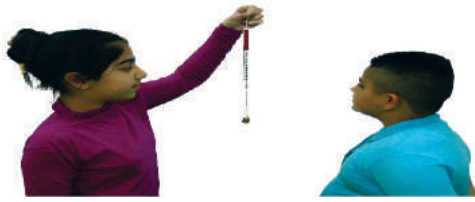
يعلق الميزان النابضي بصورة عمودية عند قياس وزن الجسم
