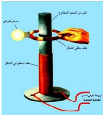
ملف بشكل اسطوانة مجوف - ملف حلقي - مصباح كهربائي - مصدر للفولطية المتناوبة - ساق من الحديد المطاوع طويل نسبياً تربط الأدوات كما في الشكل
